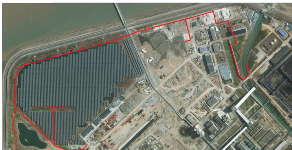
图6 电缆铺设走向
