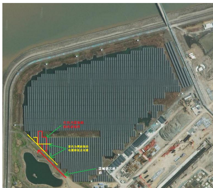
图 7 需拆除组件、需电缆桥架及器械进出路线
