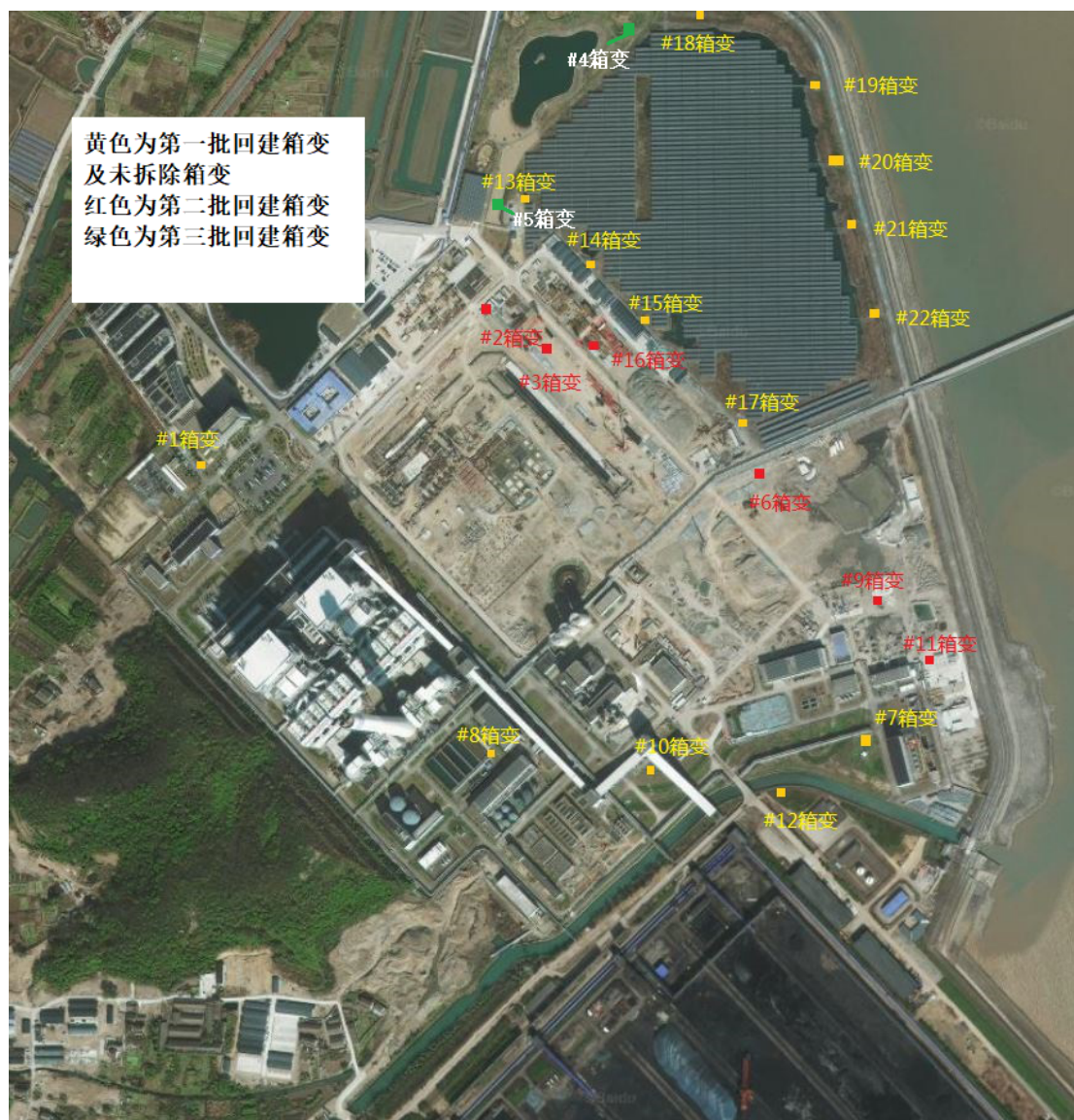
图 5 厂区箱变安装示意图
