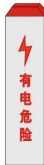
水泥地下电缆标识示意图
