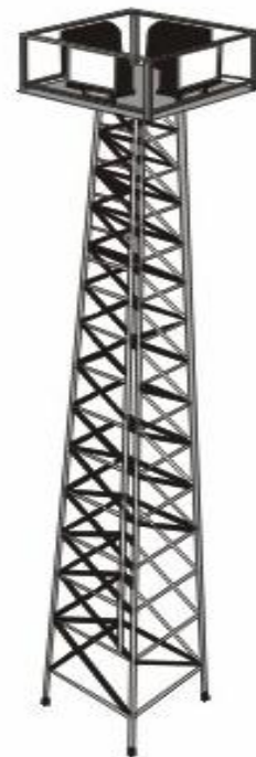
固定式照明灯塔结构示意图
