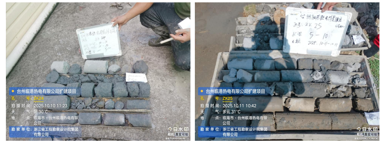
图 3.4-2 ZK24 揭示的水泥土
